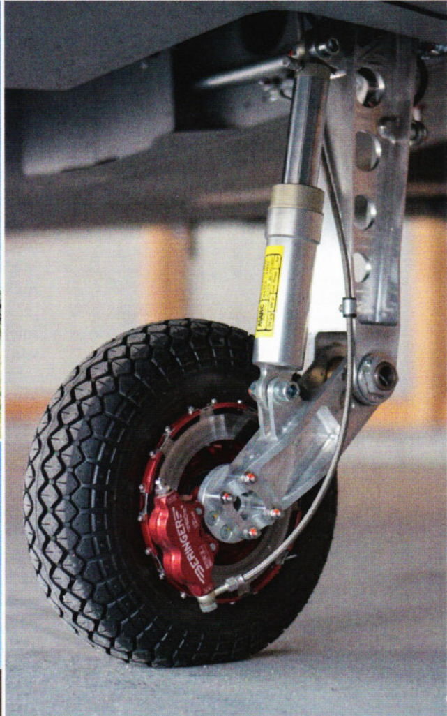
Aus Alu gefräst: Hauptfahrwerksbein mit gezogener Schwinge. Die Öl-Luft-Stoßdämpfer stammen von Marc Ingegno, die Scheibenbremsen von Beringer
