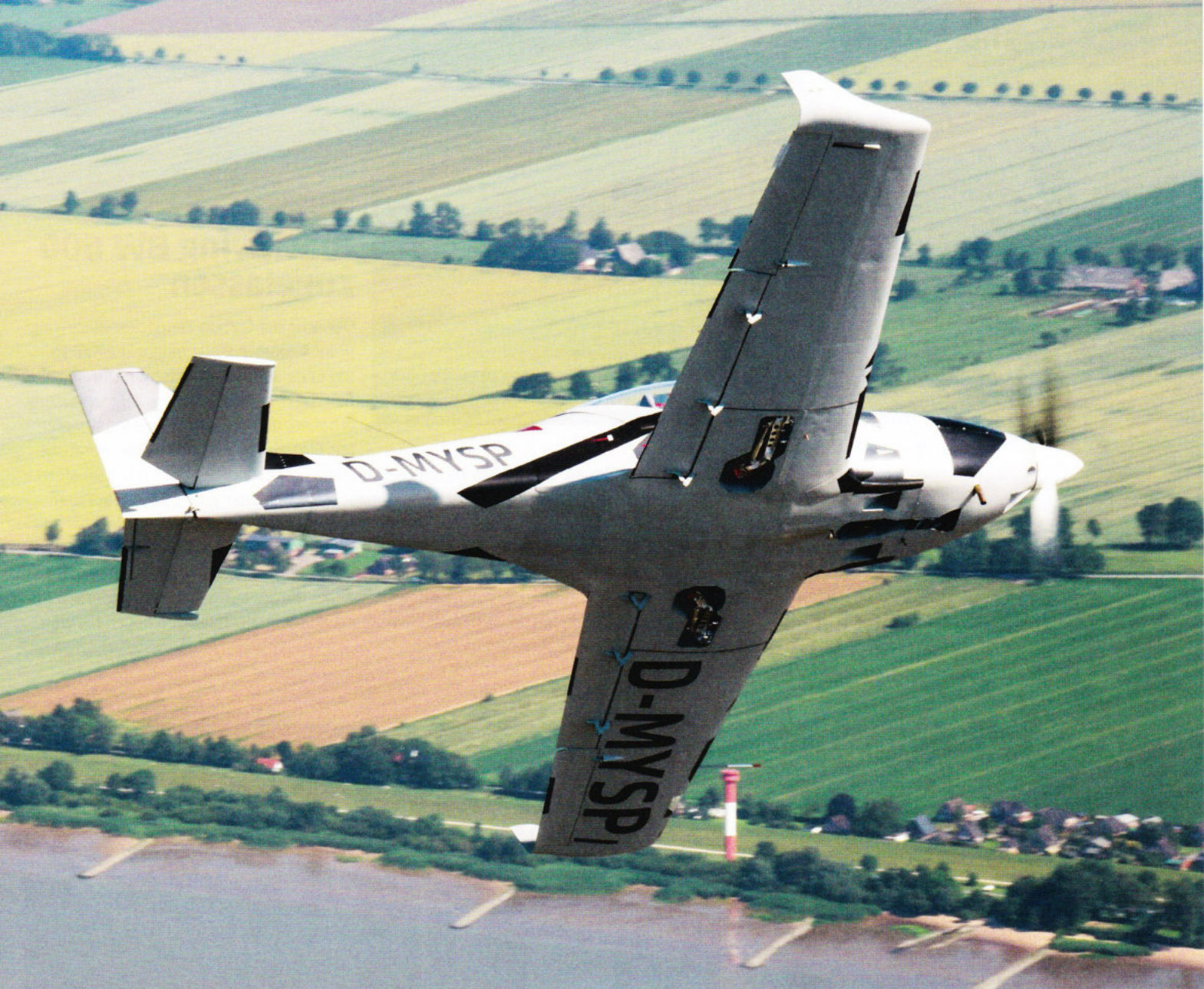
Fowler-Spaltklappen: Damit bleibt das 600-Kilo-UL deutlich unter der geforderten Stallspeed von 83 km/h
