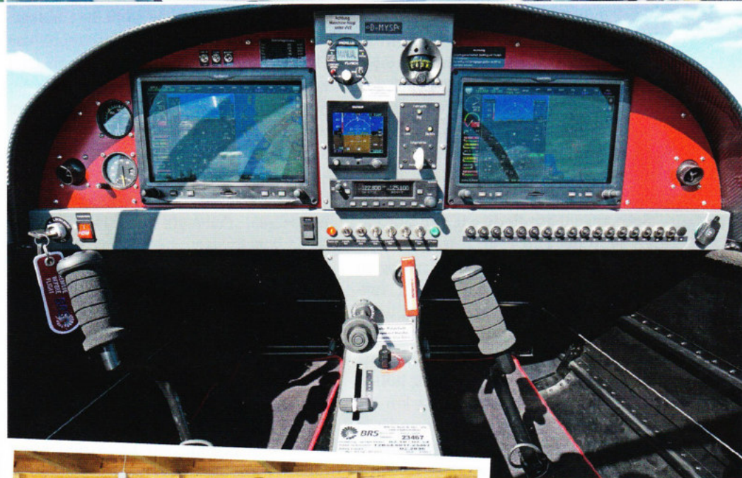
Mit Garmin-Glascockpit: Standard sind analoge Fluginstrumente. Beide Piloten erreichen alle wichtigen Hebel und Schalter in der Mitte
