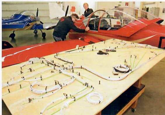
Ganz nach Plan Sammelbrett für einen Kabelbaum. Weil das UL schwerer sein darf, gönnt Breezer den neuen B400-6 eine Elektrik mit Luftfahrt-zertifizierten Kabeln. Der komplette Kabelbaum wiegt 7,5 Kilogramm
