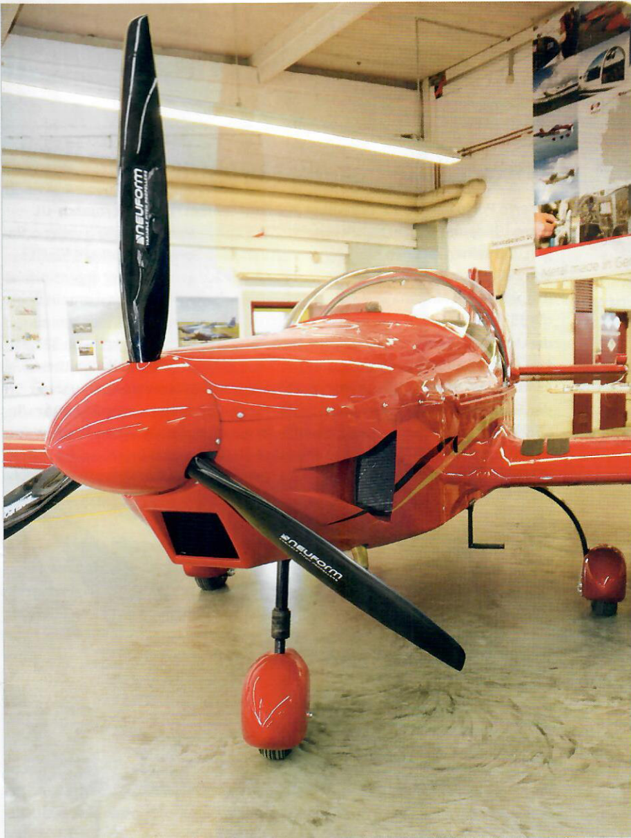
Kühl bleiben Breezer B400-6, die mit einem Rotax-Einspritzmotor geordert werden, erhalten eine neu geformte Cowling mit großen NACA-Einlauf wie beim Breezer Sport
