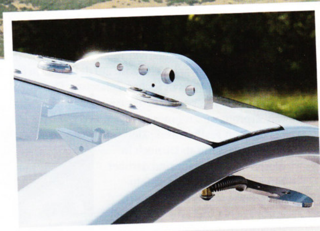
Feines Detail: Der Haubenverschluss gleicht einem Flügelprofil. Im Metallbau hat Breezer Aircraft ein hohes Niveau erreicht
